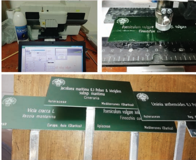
Fig. 3 Le varie fasi del processo di produzione del cartellino: progettazione su apposito software (in alto a sinistra), stampa mediante panto-grafo, montaggio su asta metallica (in basso) in modo da permettere la messa a terra finale.
